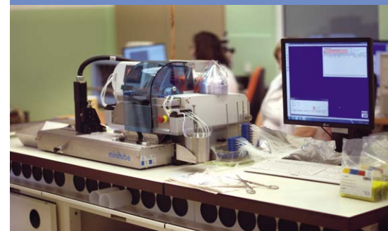
Plnicí systém MPP Quatro je řízen počítačem a napojen na centrální program IDA
