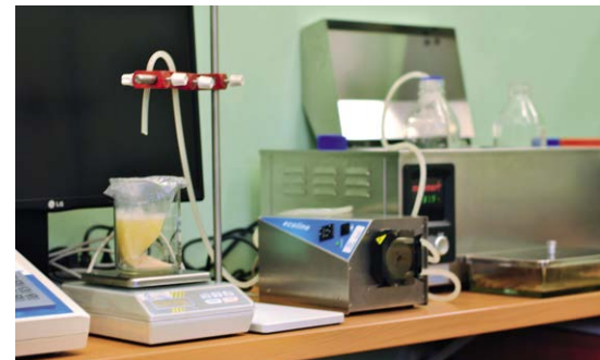
Systém automatického ředění spermatu. Ředidlo je dávkováno přímo z vodní lázně předehřáté na požadovanou teplotu
